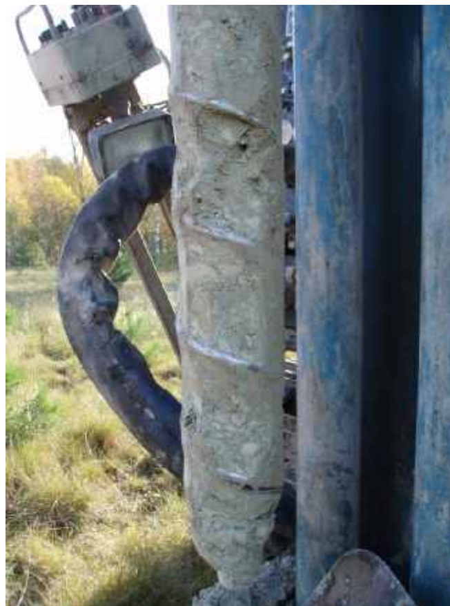
Figur 5 Gråvit, delvis hopklumpad aftersand. Klumparna bestående av finare fraktioner är leriga och smulas lätt sönder mellan fingrarna om de är torra och kan rullas till fina strängar” vid måttlig fuktighet.
