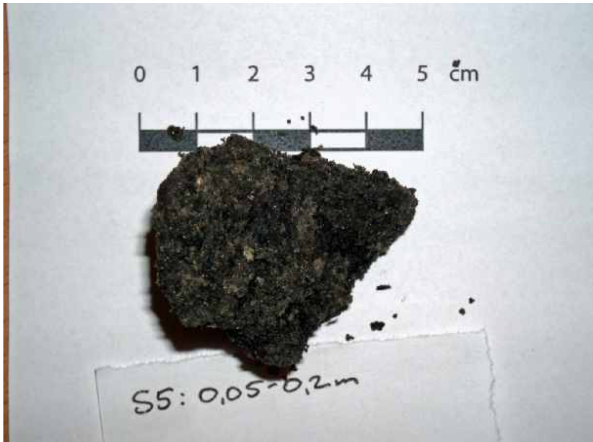
Figur 17 Slaggvarp kan förekomma tillsammans med andra avfall. I detta fall tillsammans med aftersand (grått finkornigt material) samt kolrester (svart finkornigt material). Tvättning kan behöva ske för att korrekt identifiera avfallet. Slaggen får då ofta en tämligen blank, glansig yta.
