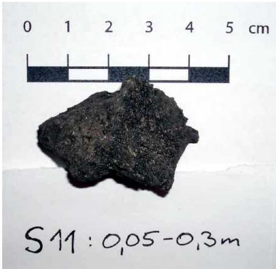
Figur 23 Exempel på en porösare slagvariant (lätt) vilken liknar "pimpsten". Något gråare än de tidigare presenterade i färgen. Relativt skarpa kanter.
