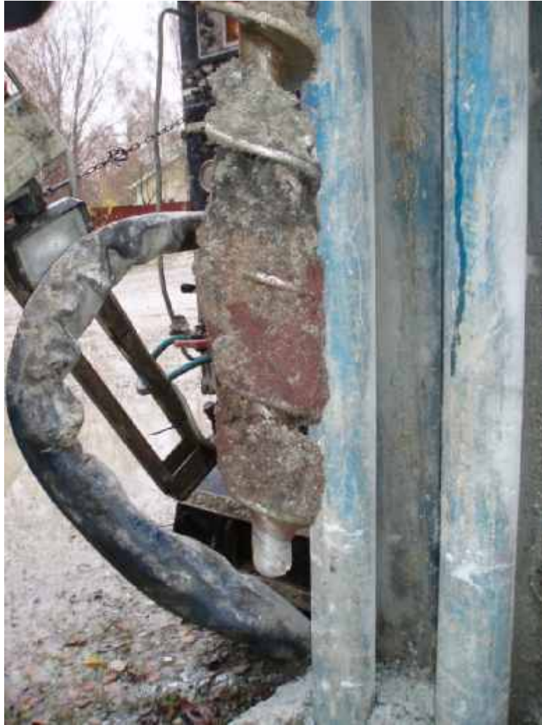
Figur 26 Övrigt finkornigt avfall illustreras ovan av det rödaktiga lagret på borren vilket troligen är en rostad mellanprodukt eller lakrest.
