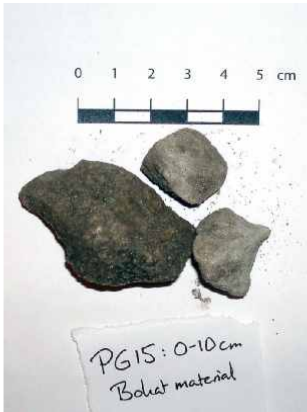
Figur 11 Även vid bokningen bildade en del material avfall. Det krossade avfallet (bokade) bör ha en sida understigande 5 cm, relativt kantigt samt vara relativt fattigt på blyglans och i huvudsak bestående av dolomit.
