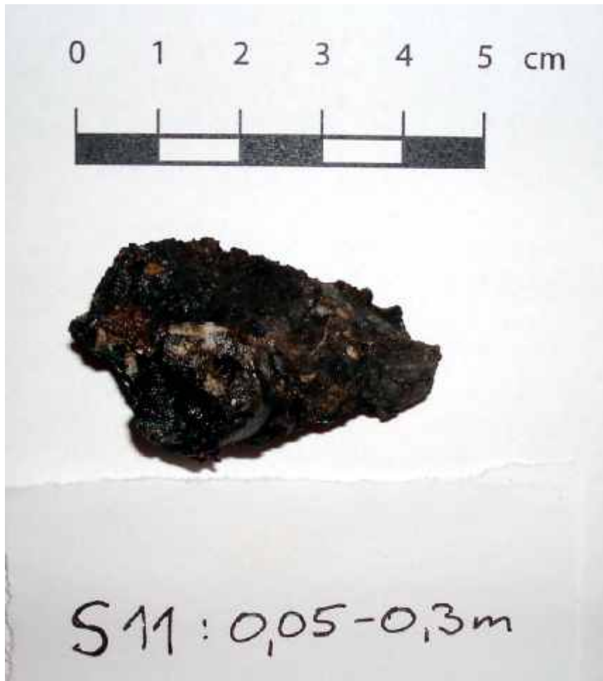
Figur 22 Slagg kan även innehålla andra färgvariationer. Olika föreningar kan ge vita/gula/röda färgskiftningar och upplevs ligga som en utfällning på ytan.
