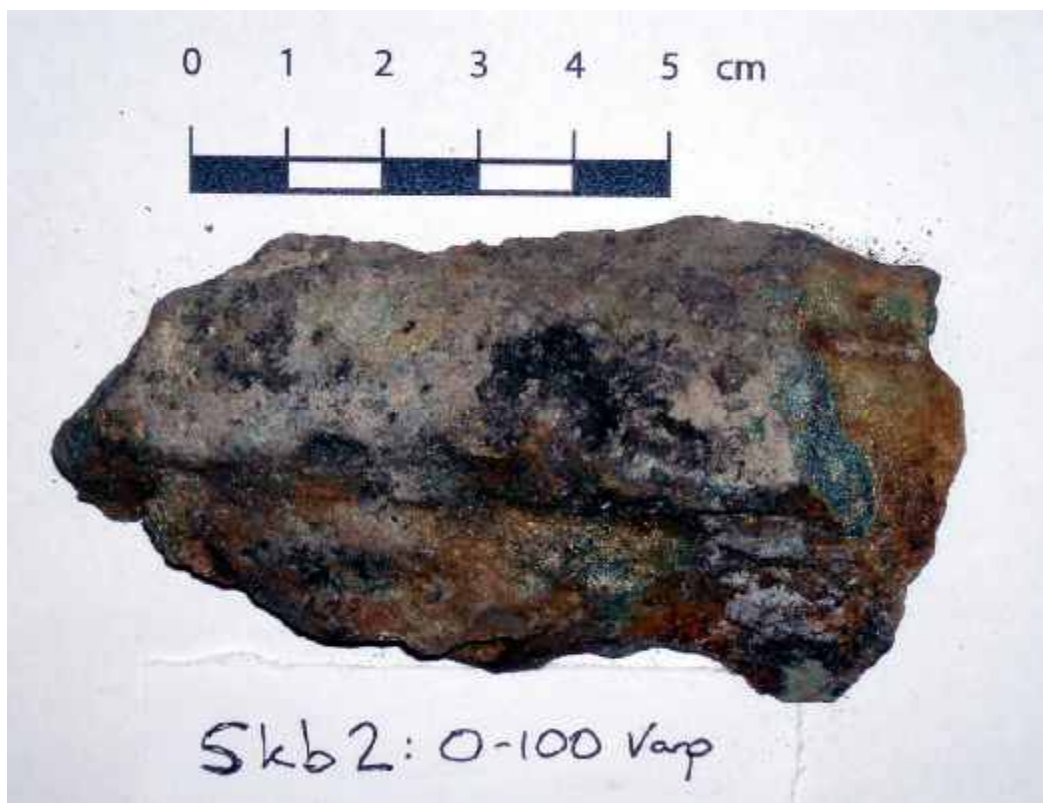
Figur 11 Även vid bokningen bildade en del material avfall. Det krossade avfallet (bokade) bör ha en sida understigande 5 cm, relativt kantigt samt vara relativt fattigt på blyglans och i huvudsak bestående av dolomit.
