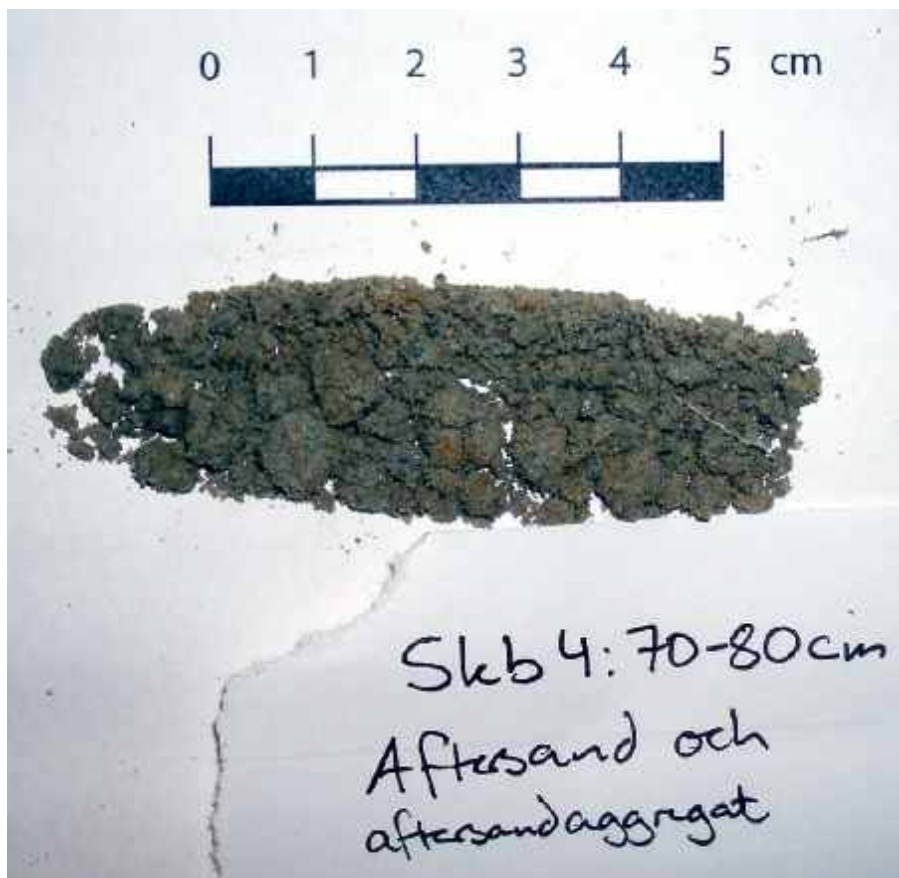
Figur 8 Ytterligare färgvarianter av aftersand som påverkats färgmässigt av järnutfällningar. i varierande omfattning. Aftersanden kan även få en något grågrön färgton beroende på innehåll av talk.
