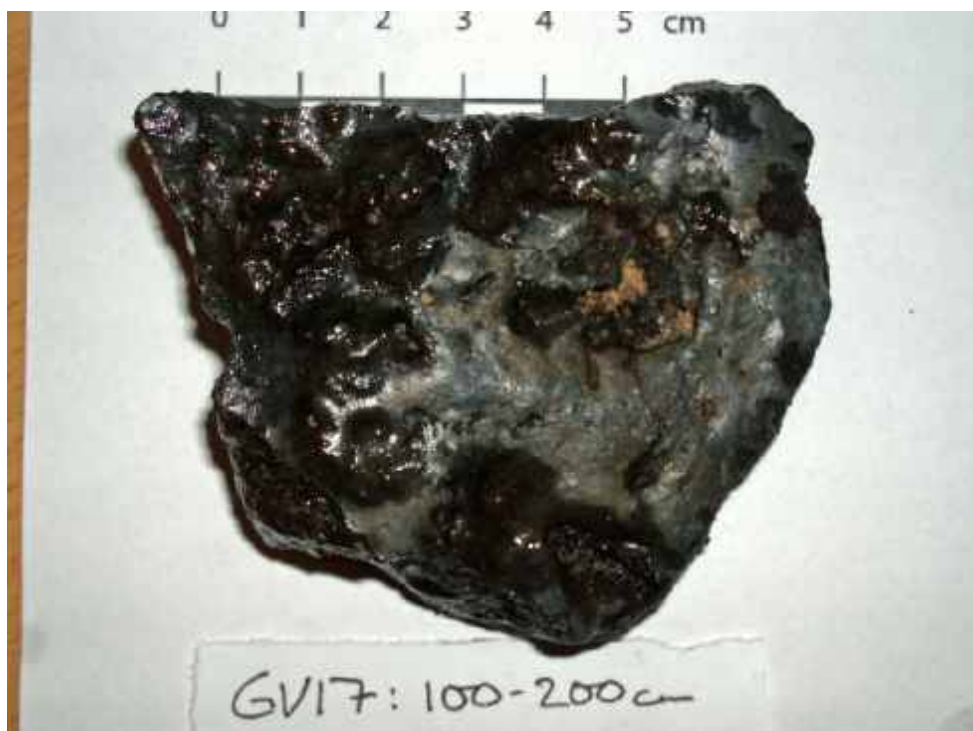
Figur 21 Slagg från överytan av smältan uppvisar större blåsor samt en ojämn (men slät) överyta. Rester av kol kan förekomma. Färgen är ofta blåaktig till blåsvart/grå.
