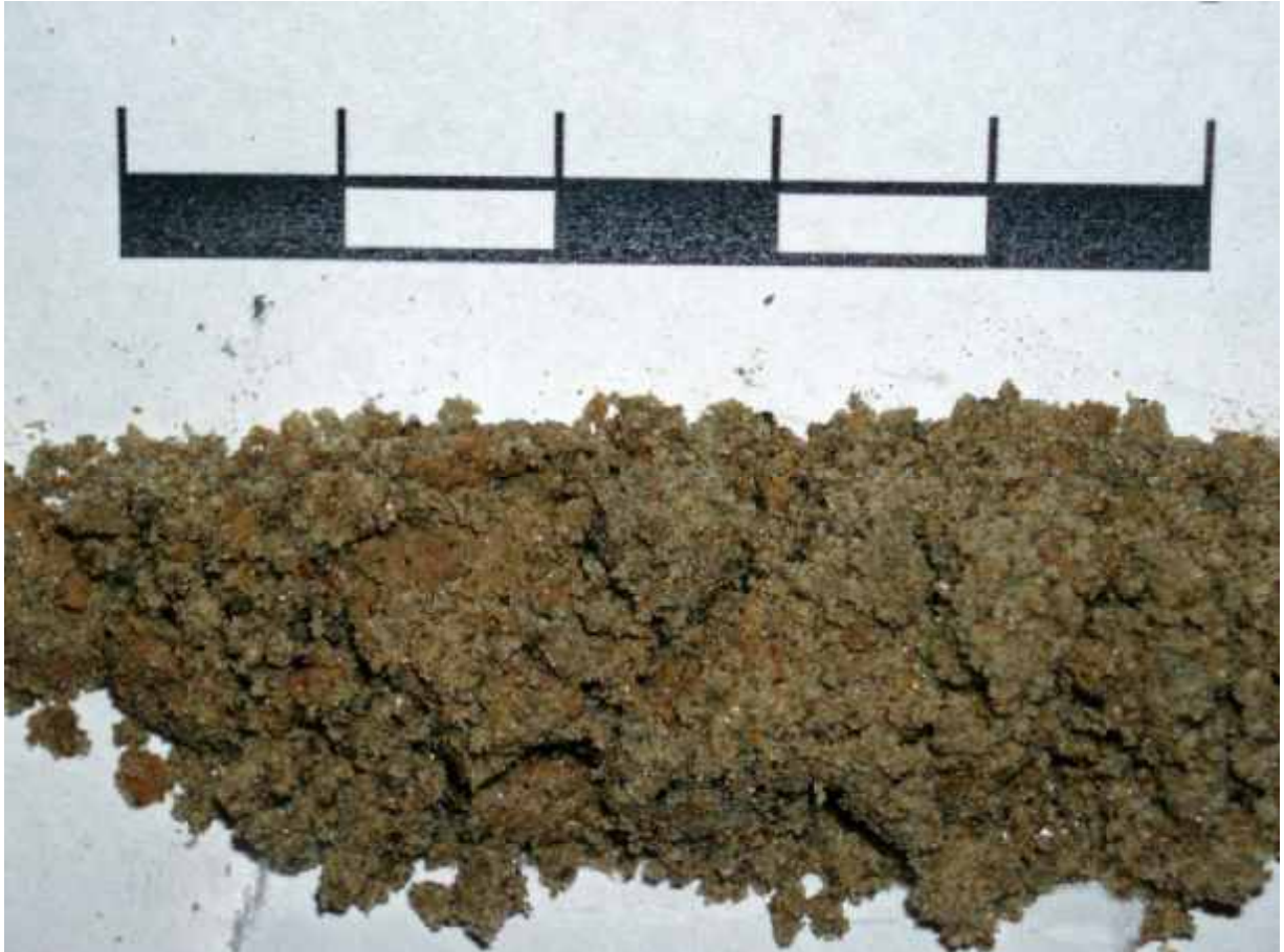
Figur 7 Foto av aftersand från anftersandskansen innehållande något järnoxider vilket ger en skiftning i färg från vit/gråvit till brunare mer rostfärgad.
