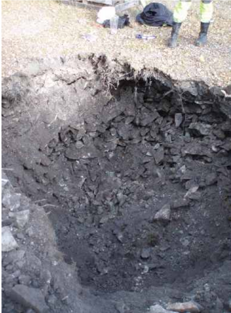
Figur 9 Provgrop med innehåll av varp och viss andel finmaterial som deponerats ovanpå men som i samband med grävningensarbetet fallit ner till djupare nivåer.
