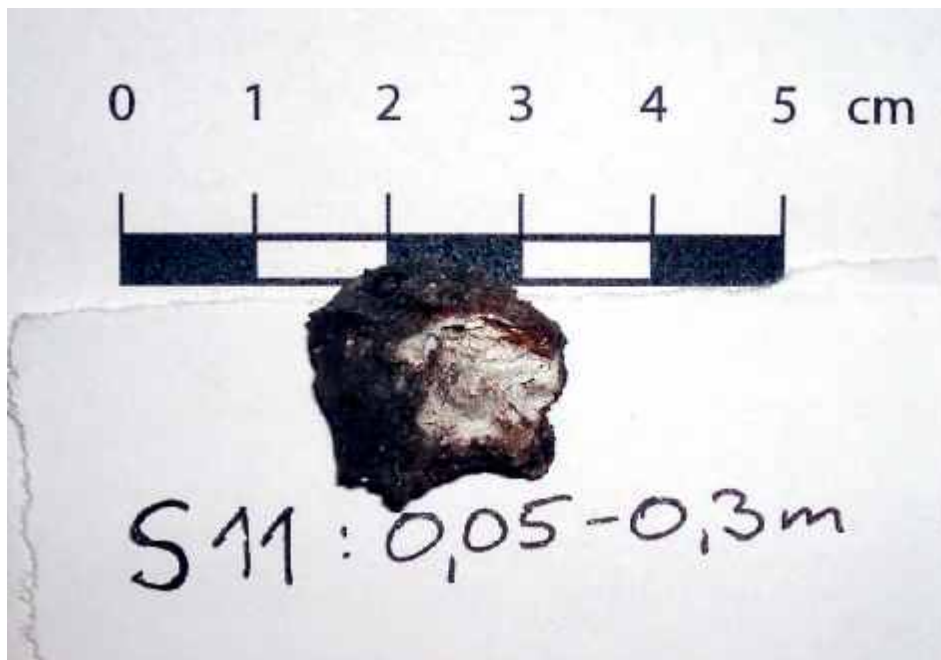
Figur 23 Exempel på en porösare slagvariant (lätt) vilken liknar "pimpsten". Något gråare än de tidigare presenterade i färgen. Relativt skarpa kanter.
