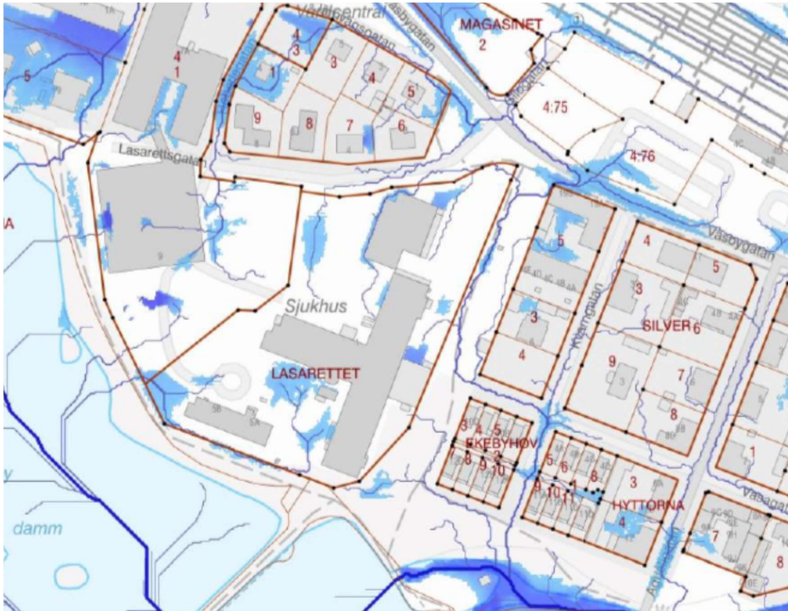
Lågpunkter och rinnvägar i närheten av planområdet vid ett ungefärligt 100-årsregn (© Scalgo Live, 2022).
