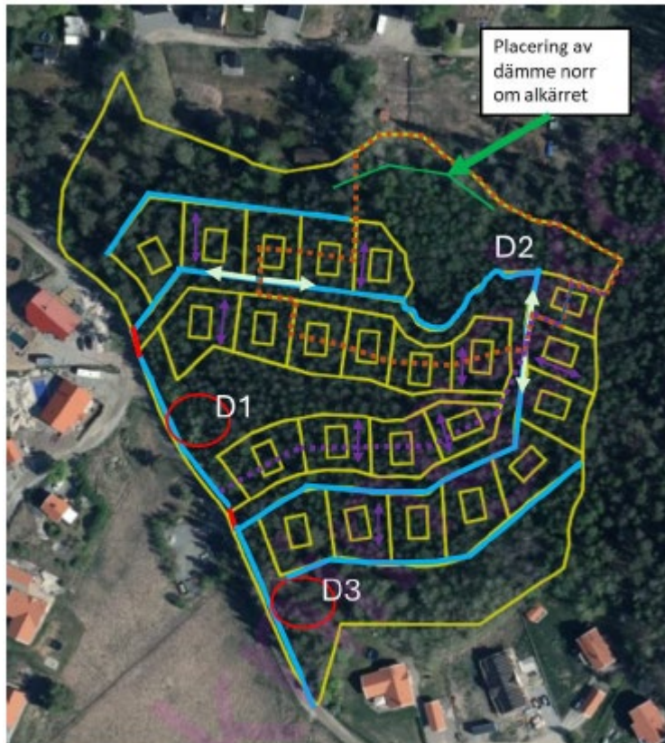
Figur 23. Avvattning av området efter exploatering förutspås ske åt tre håll D1 (lila streckning), D2 (orangea streckning) och D3 (resterande yta). Röda cirklar visar förslag till placering av fördröjande åtgärder för att förhindra översvämning nedströms i systemet. Blåa streck visar förslag på placering av diken i området. Grönt streck visar förslag på placering av ett dämme.
