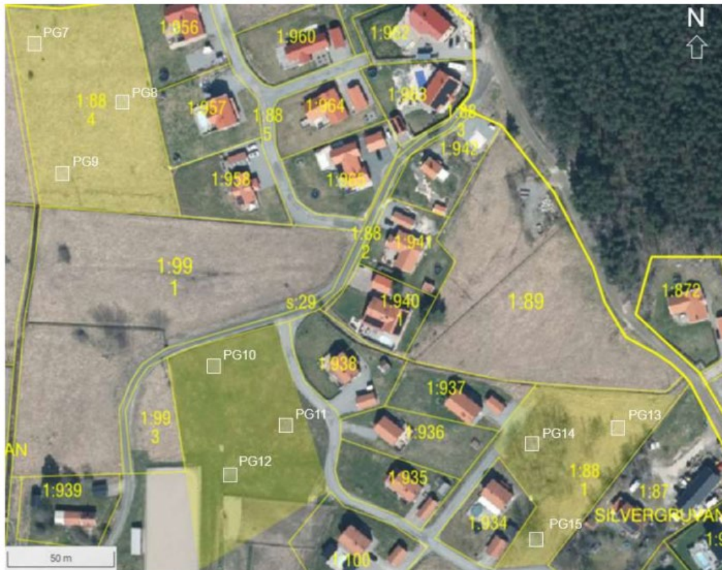
Figur 15. Ungefärligt läge för provgropar (PG7-PG15) inom delar av fastigheten Silvergruvan 1:88.
