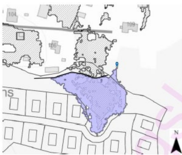
Figur 24. Simulering i Scalgo som visar potentiell fördröjningsvolym vid placering av ett dämme enligt svart streck i figuren och höjd på ca 0,5 m.
