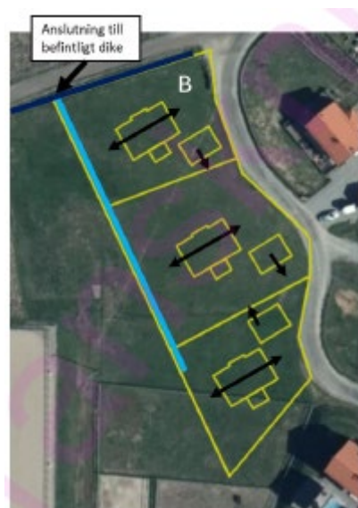
Figur 21. Rekommenderad dagvattenhantering för område B. Ljusblåa streck
