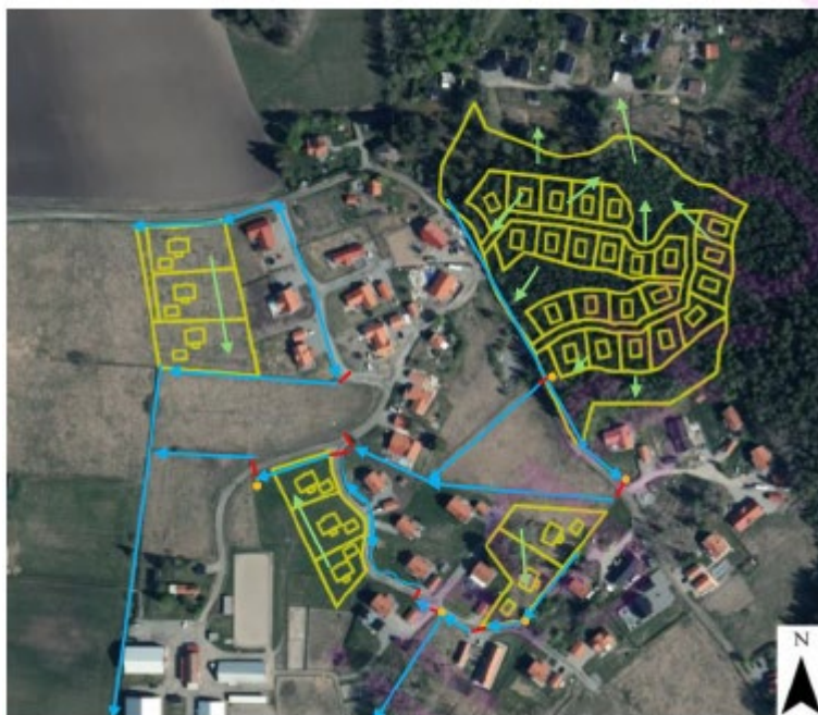
Figur 19. Befintlig avvattning och avrinning från området. Blåa pilar visar befintliga öppna diken och dränering under mark. Gröna pilar visar flödesriktning för det yttligt avrinnande vattnet. Röda streck visar placering av befintliga vägtrummor. Orangea cirklar visar befintliga brunnar.
