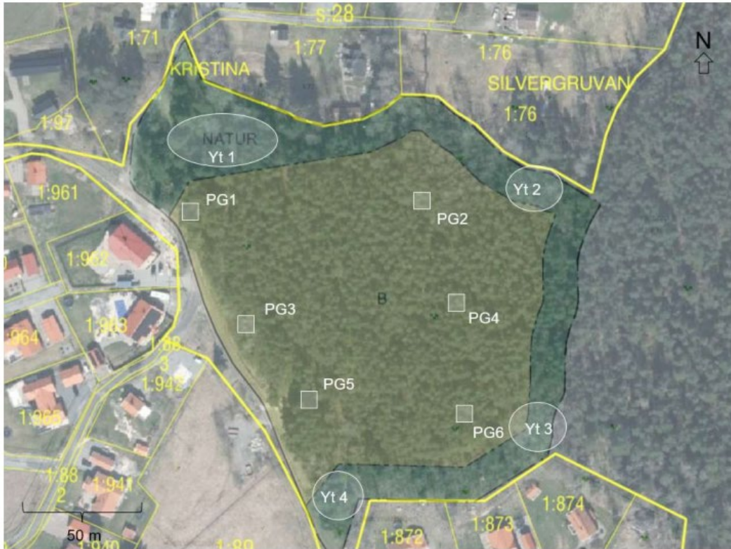
Figur 14. Ungefärligt läge för provgropar (PG1-PG6) och samlingsprov från ytjord (Yt1-Yt4) inom fastigheten Kristina 4:15.
