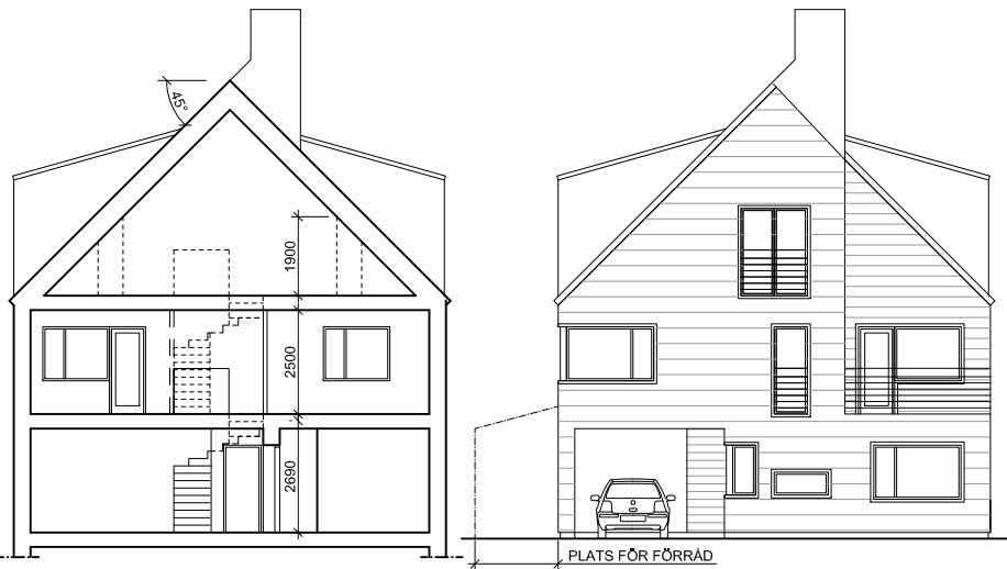
SEKTION A-A MED INFART VAGNSLIDER PÅ GAVEL
