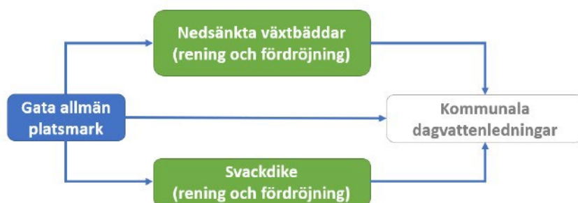
Figur 42: Schematisk skiss över förslag till dagvattenhantering inom allmän platsmark (WRS 2025)
