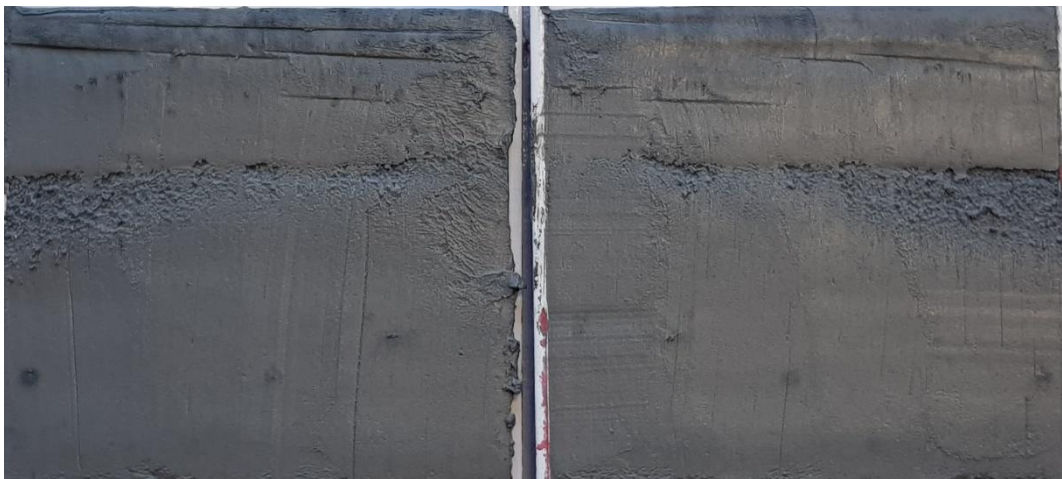
Figur 8 Borrpunkten, BG20041, 3,5 m, Jordprovet i nedre delen av mellanhylsan delad longitudinellt provhylsan med id Bjerking S 566.
