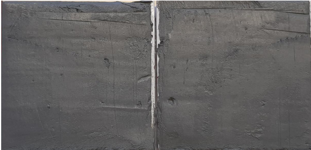
Figur 4 Borrpunkten, BG20010, 4,5 m, Jordprovet i nedre delen av mellanhylsan delad longitudinellt provhylsan med id Bjerking 973.
