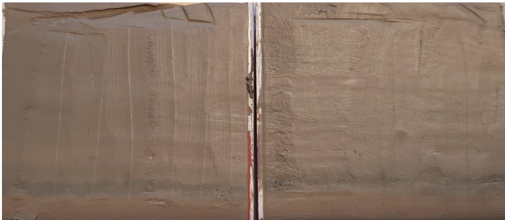
Figur 2 Borrpunkten, BG20004, 4,0 m, Jordprovet i nedre delen av mellanhylsan delad longitudinellt provhylsan med id Bjerking 275.
