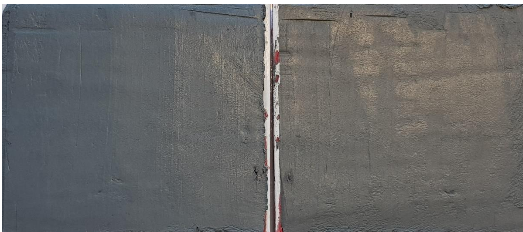
Figur 6 Borrpunkten, BG20023, 3,0 m, Jordprovet i nedre delen av mellanhylsan delad longitudinellt provhylsan med id Bjerking 358.
