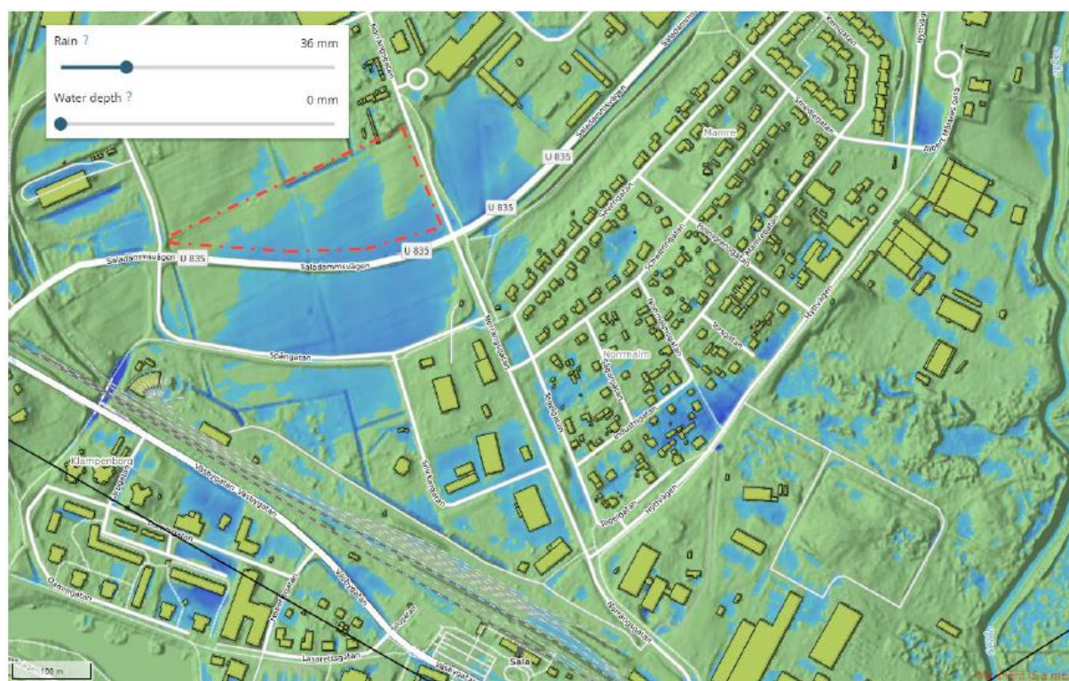
Figur 15. Områden där vatten ansamlas vid ett 100-årsregn med en varaktighet på 30 minuter. Detaljplaneområdet är markerat med röd streckad linje (WSP, 2021a).
