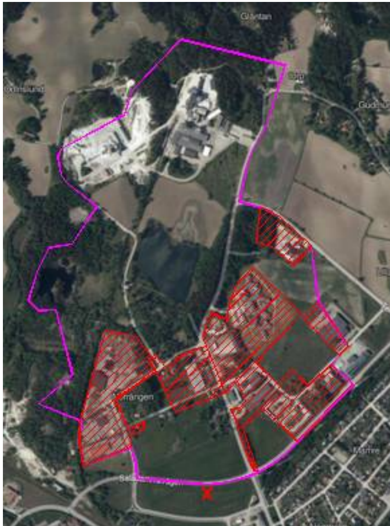
Figur 4. Kartan visar avrinningsområde (magentafärgad linje) som vid ytligt rinnande dagvatten avvattnas till punkt X. Rödmarkerade områden är anslutet till dagvattenledningar. Bakgrundsbild hämtat från Hitta.se
