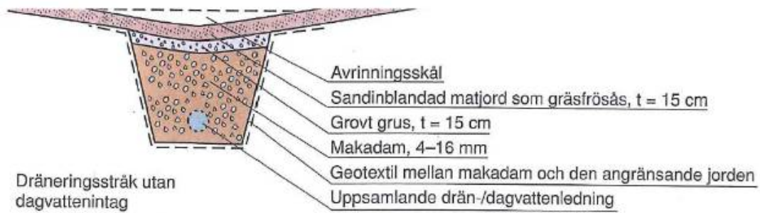
Figur 13. Principskiss för makadamdike med fördröjningsvolym ovanpå bädden.
