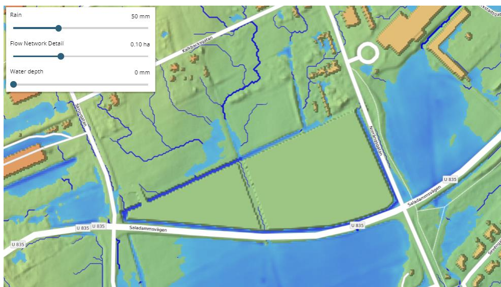
Figur 3: 50 mm regn med lokalgata inlagd, med kulvert.
