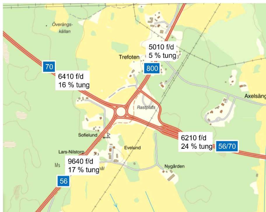
Figur 5 Antal fordon/dygn i genomsnitt över året, procentandel av tung trafik såsom lastbil och bussar. (Källa: Trafikverket klickbar karta, TIKK samt Sala kommuns mätning 2021)
