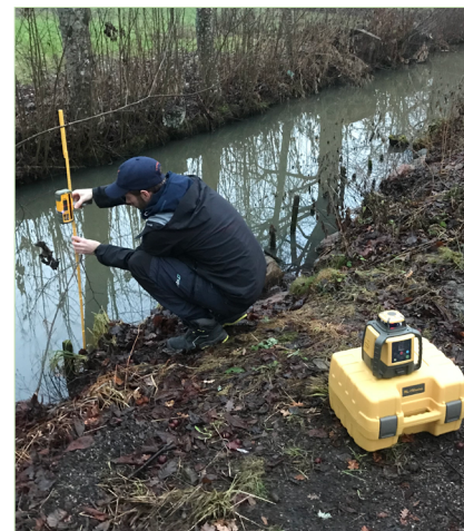
Mätning av nivåer i grundvatten och på Pråmåns yta. Foto: Johan Norrlin, Sala kommun
