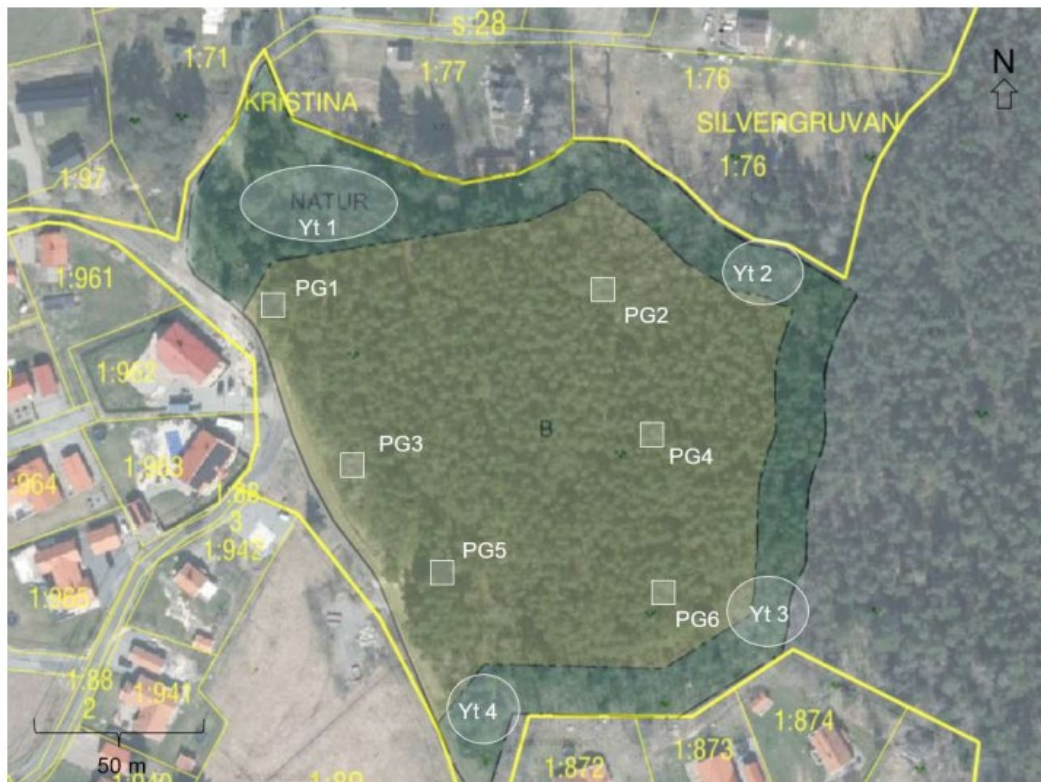
Figur 14. Ungefärligt läge för provgropar (PG1-PG6) och samlingsprov från yttjord (Yt1-Yt4) inom fastigheten Kristina 4:15.
