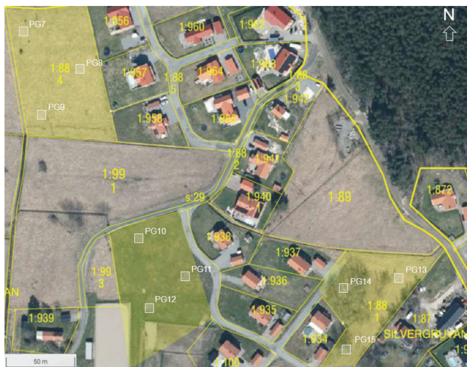
Figur 14. Ungefärligt läge för provgropar (PG7-PG15) inom delar av fastigheten Silvergruvan 1:88. Bakgrundsbild från https://minkarta.lantmateriet.se , ©Lantmäteriet. I Bilaga 1 finns en koordinatsatt ritning.
